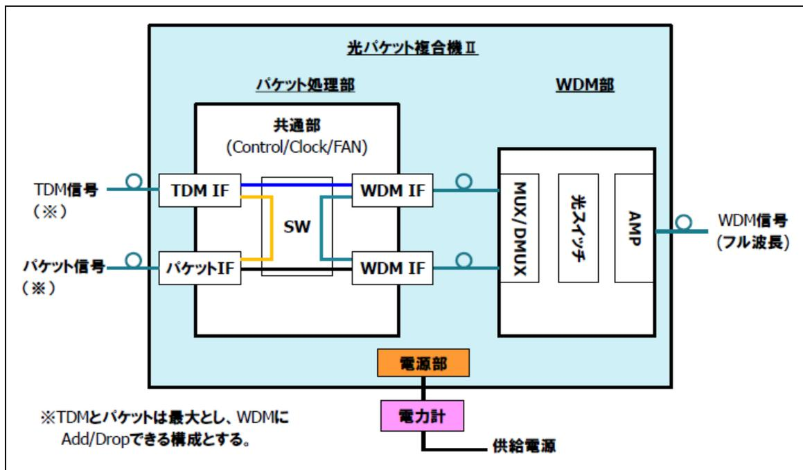
【 $P_{idle}$ 測定時の構成例(最小実装の最小パス構成)】
