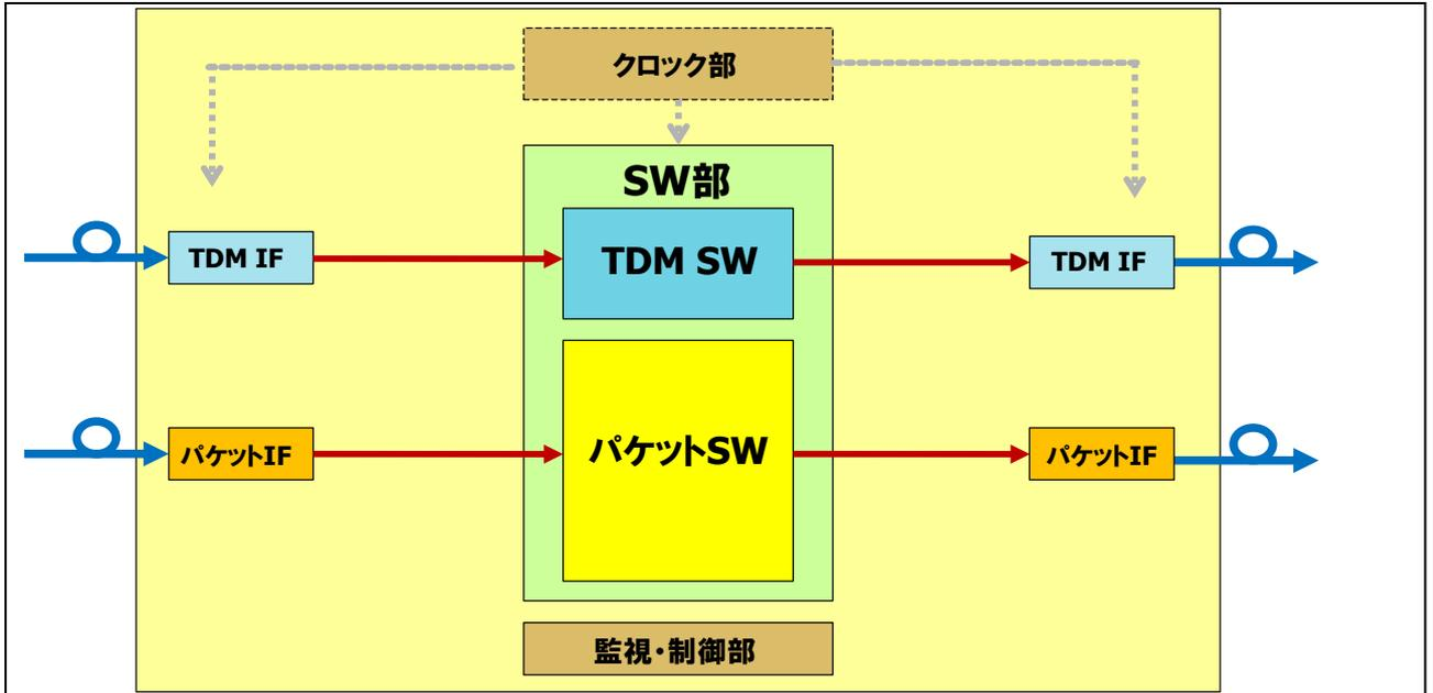
モデルⅡ：TDM信号を一部パケット化して、パケットスイッチにてスイッチング、または、パケット信号を一部デパケット化して、TDMスイッチにてスイッチングする構成
