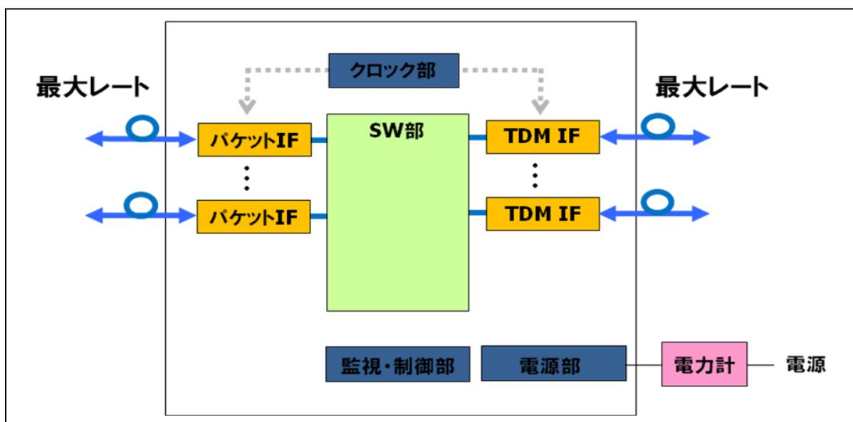
【P<sub>idle</sub>測定時の構成例(最小実装の最小パス構成)】
